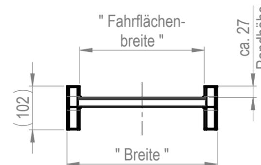
\*Die Tragkraftangaben gelten pro Paar und beziehen sich auf ein zweiachsiges Fahrzeug mit einem Achsabstand von 1500 mm und einer gleichmässigen Lastverteilung (50% zu 50%).
